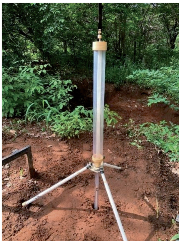
Figura 3. Ensaio de permeabilidade com Permeâmetro de Guelph na área de estudo.
